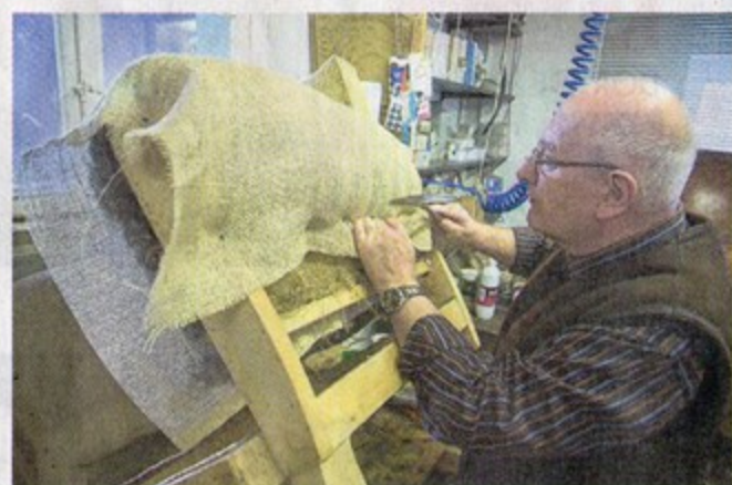
Jean-Pierre Bachschmidt en train de rembourrer un fauteuil. Il utilise du crin, de la mousse, de la ouate de coton.
